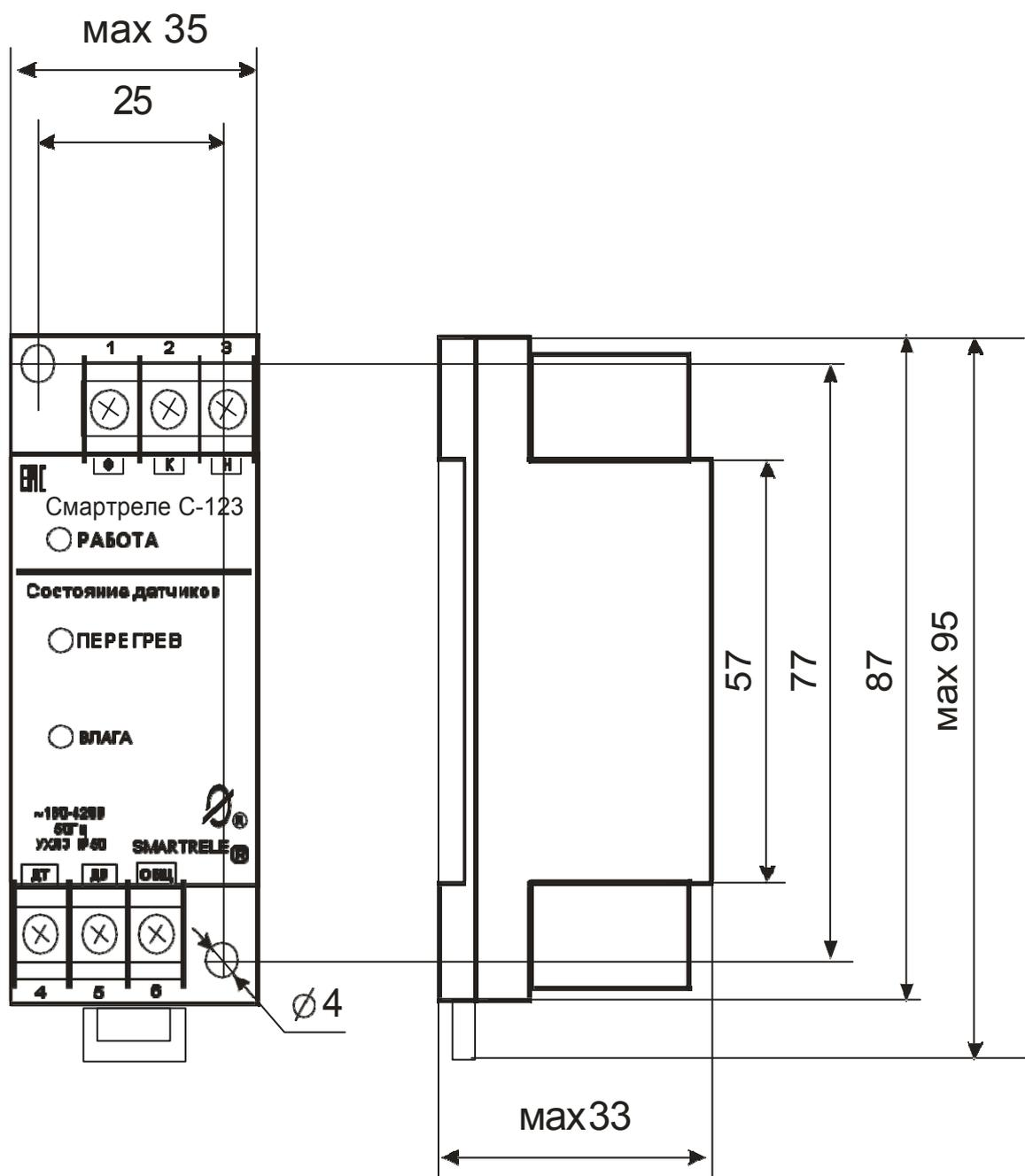
Рисунок -1 внешний вид, габаритные и установочные размеры реле
